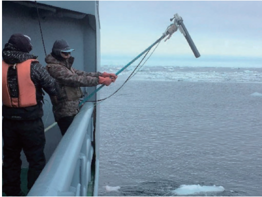
図8. XCTDによる海洋観測の様子。
