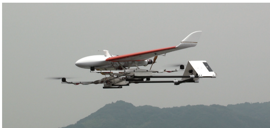
図2. 2019年に開発した第二段階実証機(飛鳥改二) 翼長1.8m 重量12.6Kg。
