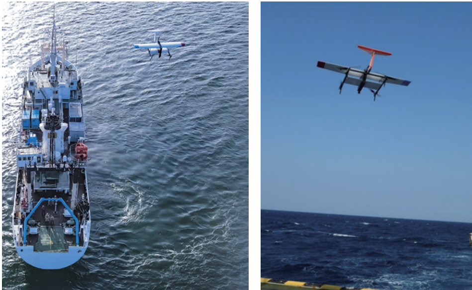
図6. 2021年3月25-29日に三河湾において実施した飛行試験。左：停船中の調査船後部甲板から垂直離昇中の飛鳥改四。この後、自律飛行に移行して風速10-15 m/sの中、航空資源調査を実施した。右：全速力航行中の調査船後部甲板へ着船中の飛鳥改四。海面も白波が立っている状態。
