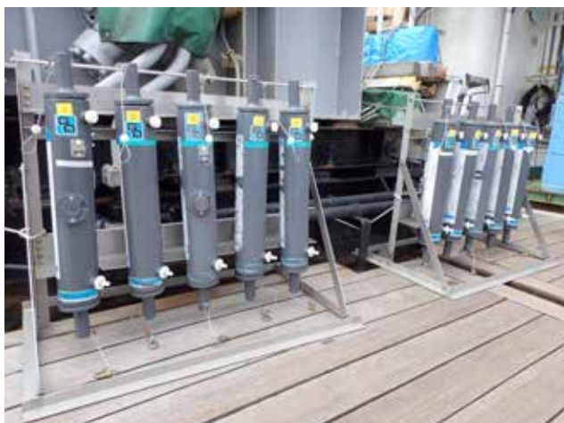
図15. 第七開洋丸で使用したニスキン採水器。
