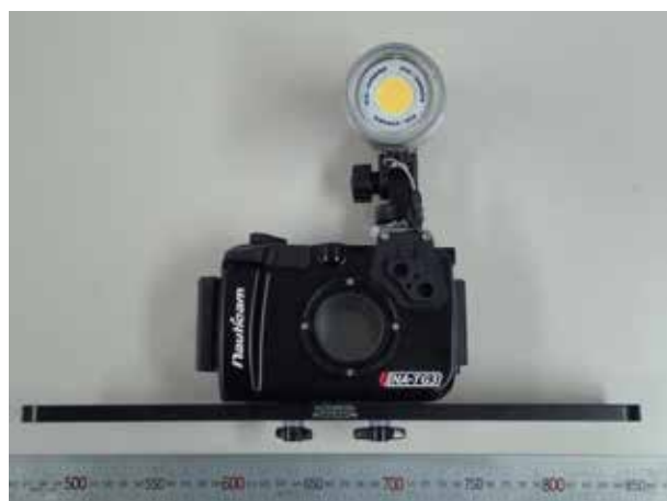
図12. オキアミ類を誘い集める目的で小口径リングネットに取り付けたLEDライトとカメラ。
