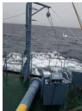
図5. 第三勇新丸に設置された電動ウィンチ。
