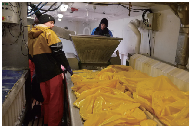
図 10. Kato 号に据え付けられた肉骨粉の冷凍装置。甲板ハッチの大型クラッシャーで砕いた骨塊を写真奥の装置でさらに細かく砕き、柵目上の冷凍機に分配することで出荷用の冷凍品を作る。
