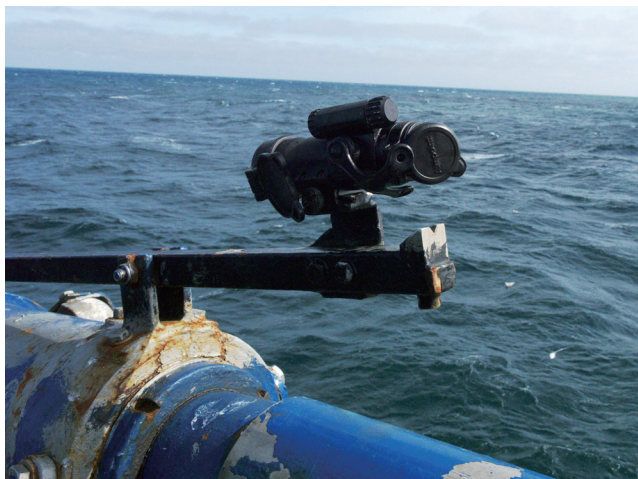
図4. 捕鯨砲の照尺に取り付けられた光学式照準器。
