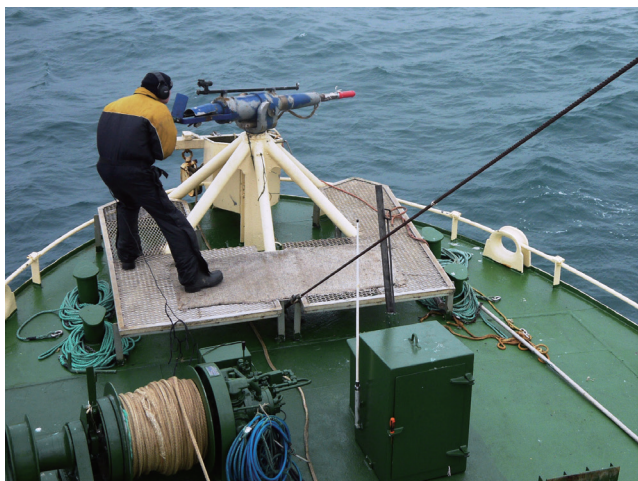
図3. 60mm 捕鯨砲は、国内唯一のメーカーである Henriksen 社製である。ウィンチは日本の捕鯨船に比べると小型で一基しかない。
