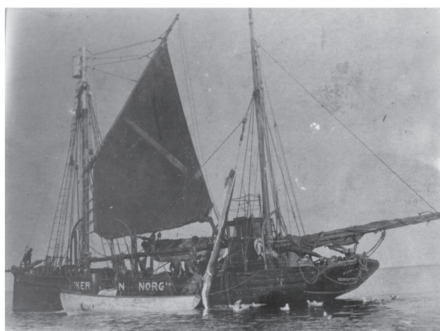
図2. 初期の小型捕鯨船。船首（左側）に捕鯨砲、前方マスト上に見張り台（クローズネット）が備えられている。中央付近では甲板上及び船外のボートから数名で鯨の解体作業をしており、後方マストの滑車からは鯨体から剥された脂皮が吊り下がっている。撮影時期・船名は不明。（Kato号船内掲示の写真を撮影）。
