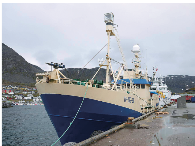
図3. 捕鯨船Kato号。造水器や冷庫、衛星通信システムなどを備え、スピッツベルゲン島（スパールバル諸島）やヤン・マイン島海域など沖合での長期操業が可能である。
