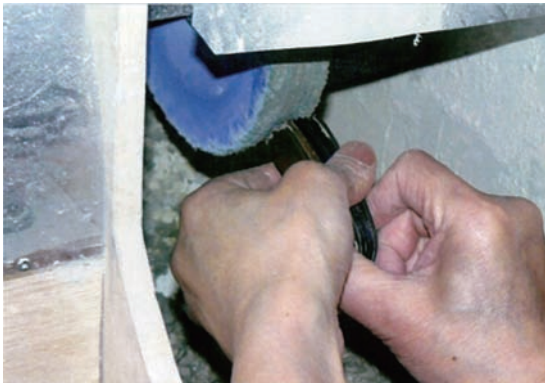
写真7. 磨き砂で荒磨きをする
