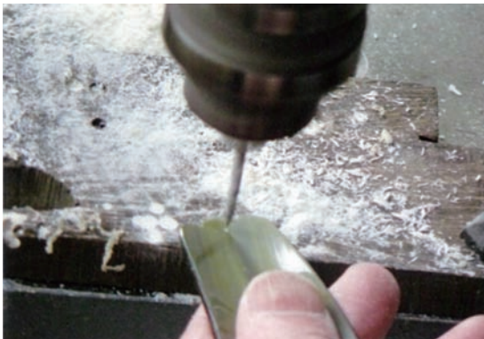
写真9. 先端部に穴を開ける
