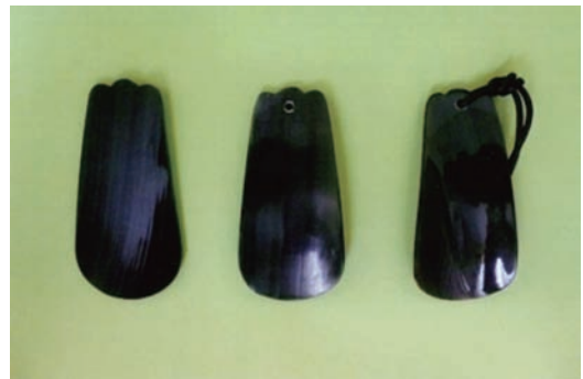
写真11. 半製品→穴開け後→紐を通した完成品
