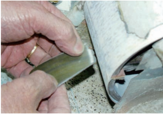
写真3. 半製品の周りを紙ヤスリをかけて整える
