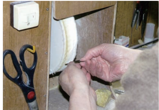
写真8. 固形ワックスで本磨きをする
