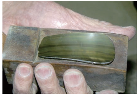
写真6. 熱処理した鯨ひげを挟んだ後の状態
