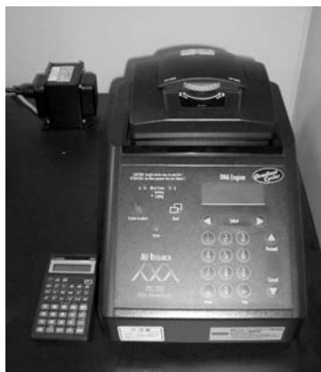
図3 . PCR装置 (プログラム付き温度制御装置) 左はメジャー用の卓上電子計算機
